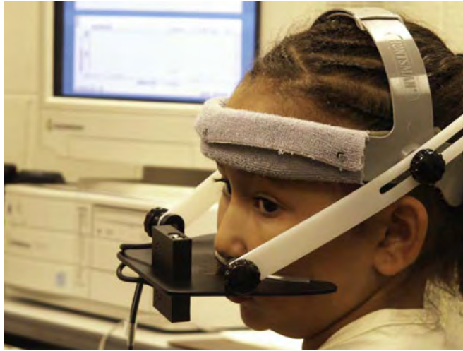
شکل ۱-۳۲: قرارگیری میکروفون‌های مانع شده روی سر برای اندازه‌گیری نازالانس
